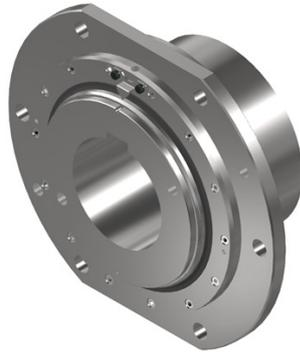
ドラムカップリングは、クレーンのワイヤドラムと減速機軸を接続するときに完璧な軸合わせが難しいため、クレーン使用時に発生する垂直荷重と軸整列誤差でギアボックスのベアリングとギアに発生する問題を解消するために作られた特殊カップリングです。
